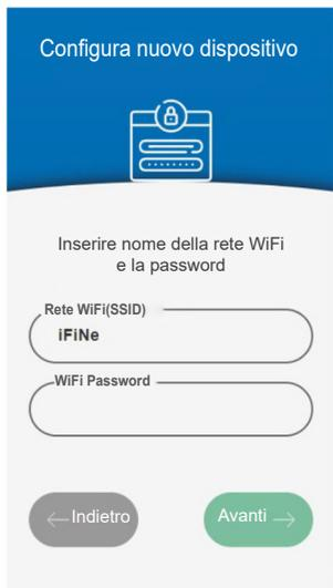
Una volta entrati in modalità configurazione del dispositivo, verranno richieste le credenziali della rete wifi su cui il dispositivo si dovrà collegare (nome rete e Password).
